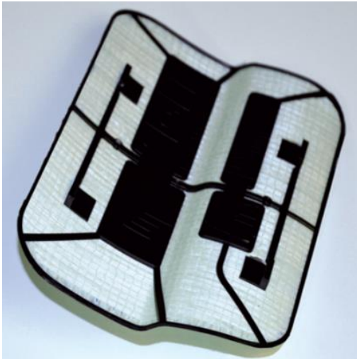
Bild 1: Tankdeckel-Demonstrator gefertigt aus mehreren Lagen Drapfix GF/PP mit anschließendem Anspritzen von Halteelementen. Der Demonstrator entstand in Zusammenarbeit mit dem Institut für Textiltechnik Augsburg ITA gGmbH.
