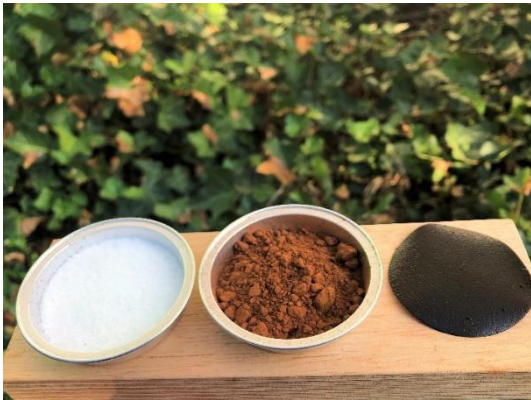
Bild 3: Die Bio-Tinte Woodmimetics3D besteht ausschließlich aus biologischen Rohstoffen wie Hydroxypropylcellulose, Lignin, Essigsäure und Wasser.
