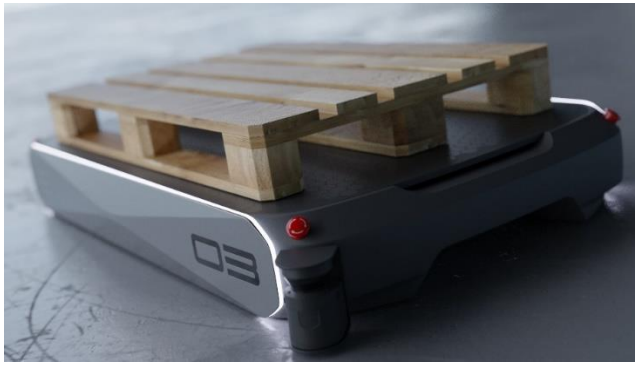
Bild 4: Das FTS mit ebener Fläche für eine Europalette
