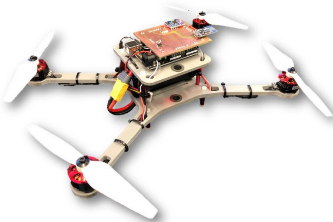
Bild 1: Leichtbau-Quadrocopter mit integrierten Auslegern und optimiertem Design
