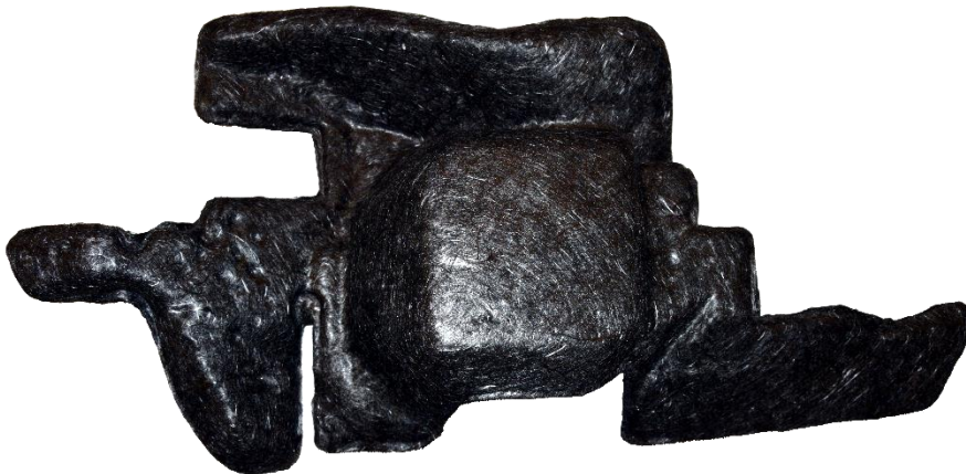
Bild 1: Formteil (Gurtabdeckung) aus Recycling Panox-Fasern.
