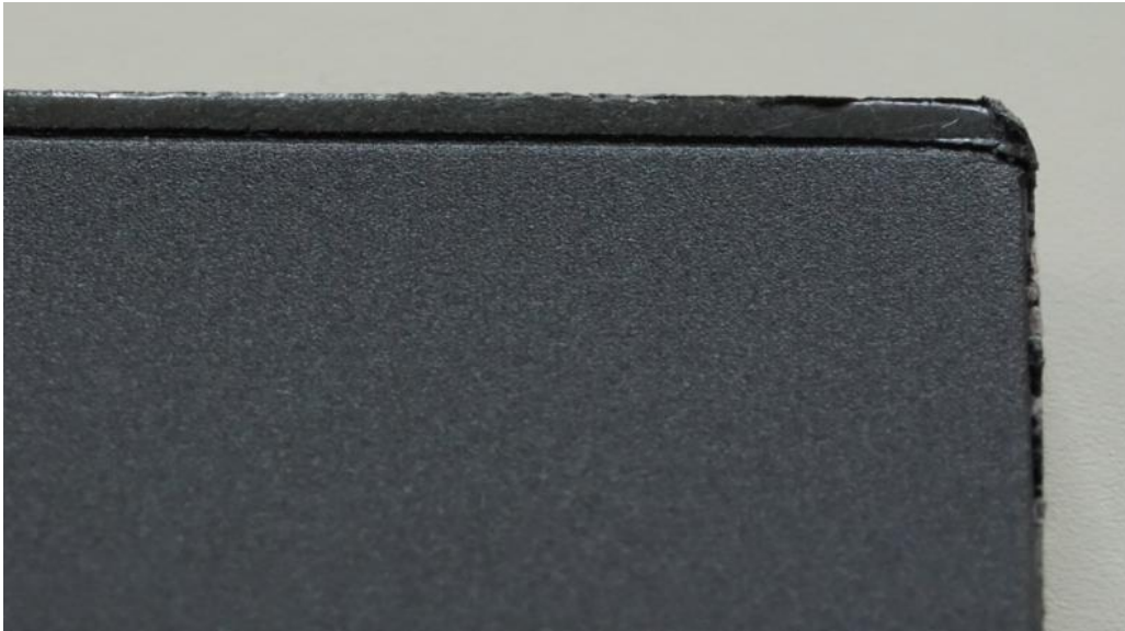
Abb.3: METAKER® Hybrid Muster. Werkstoffverbund aus Aluminium und Kunststoff (tiefschwarz im Bild) mit nachträglicher MAO-Modifikation der Aluminium-Komponente bietet zahlreiche Potenziale für hybriden Leichtbau bei unterschiedlichsten Anwendungen. http://www.automofutura.com/presse/thinking0117/thinking-hybrid.jpg
